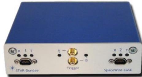
Fig. 5 Vista frontal del equipo SpaceWire EGSE [9].
