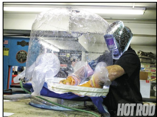
Figura 5. Cámara de purga (Fuente: www.hodrod.com)
