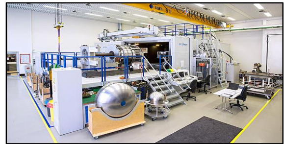
Fig. 6. Instalaciones de soldadura por haz de electrones en un centro de fabricación de tanques.
