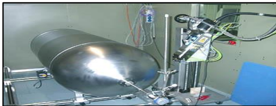
Fig. 4. Inspección por rayos-X de un tanque de combustible usado para un sistema de propulsión.
