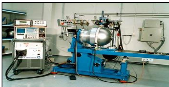
Fig. 5. Soldadura automática TIG durante la fabricación de un tanque de combustible.
