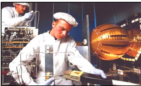
Fig. 21. Proceso de soldadura orbital en las uniones o juntas de tuberías.
