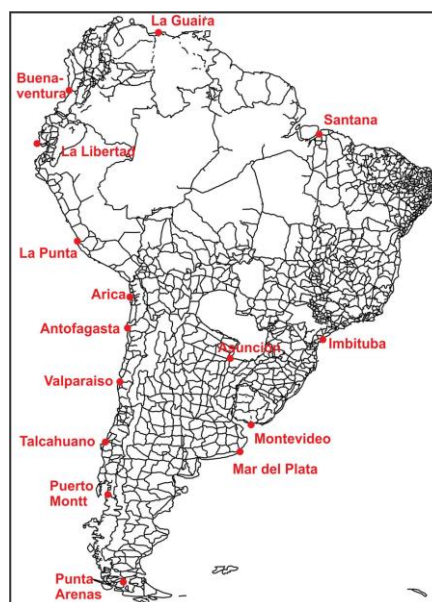
Fig. 5. Redes de nivelación geodésica en países de la región y mareógrafos de referencia.
