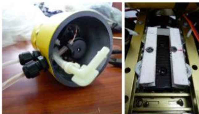
Fig. 11. (Izquierda) Sistema dinámico de flotación. (Derecha) Sistema de contrapeso longitudinal.
