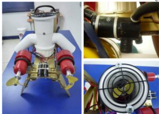
Fig. 10. (Izquierda) Se observan la configuración de los sistemas de propulsión del ROV, dos motores horizontales con abrazaderas para la fijación y la estructura del motor vertical con los desvíos inferiores de 45°. Arriba (derecha), vista de uno de los motores laterales. Abajo (derecha), vista superior del motor vertical ubicado en la tubería de PVC.
