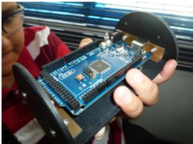
Fig. 12. Microcontrolador Arduino Mega 2560 R3 colocado en el rack del contenedor principal (base de fijación para los componentes electrónicos).
