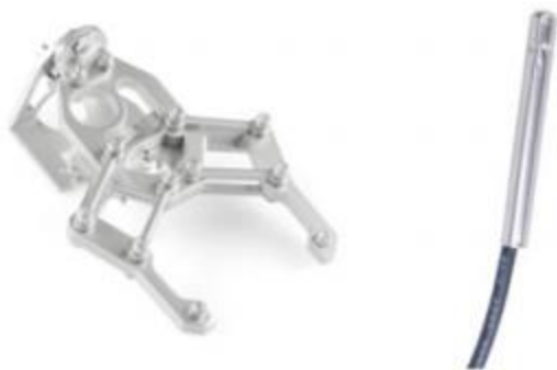
Fig. 13. Izquierda, pinza robótica adaptada como brazo de manipulación del vehículo. Derecha, sensor de temperatura digital DS18B20.
