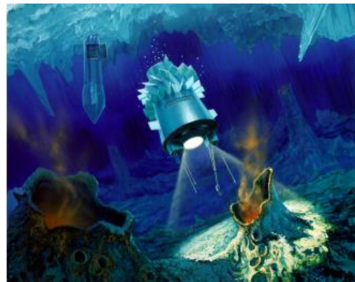
Fig. 7. En la ilustración se muestra un robot diseñado para penetrar capas gruesas de hielo (cryobot). Este se abre camino fundiendo el hielo y hundiéndose por acción de la gravedad. El cryobot luego despliega un robot autónomo submarino o AUV para explorar el océano subsuperficial de Europa.
