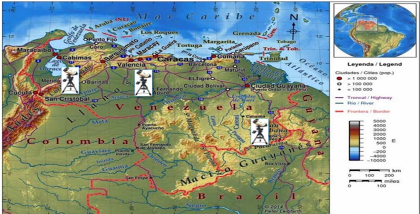
Fig. 3. Mapa de Venezuela con la distribución de la red de telescopios destinados para el proyecto de Posicionamiento Astronómico del Satelital Simón Bolívar (Pasaven). El mapa nos da una idea de la posición relativa de los observatorios y su separación. Aproximadamente 400, 700 y 1300 kilómetros de distancia.
