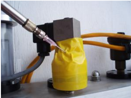
Figura 6. Prueba de fuga local utilizando método de acumulación [7].
