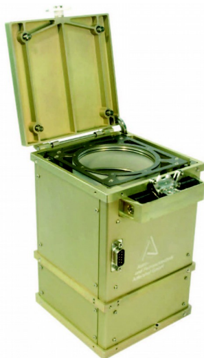
Figura 3 Simple lanzador de Picosatelites SPL [7]
