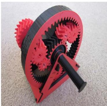
Figura 6 Impresión de un modelo de transmisión automática[9]
