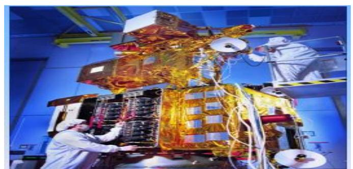
Fig. 7 Recubrimientos aislantes en los satélites
