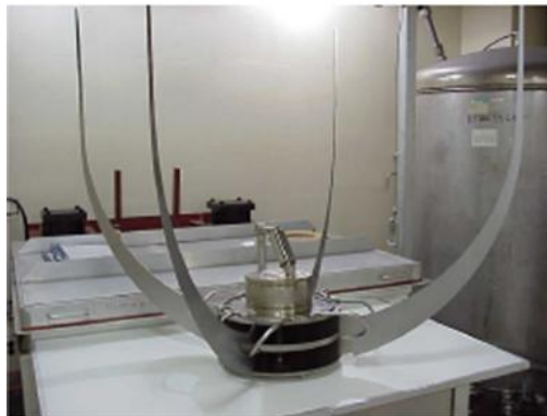
Figura 7. Modelo real de un PMD tipo vena fuera del tanque.
