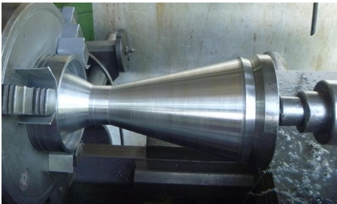
Fig. 5. Torneado de la tobera convergente-divergente del motor cohete.
