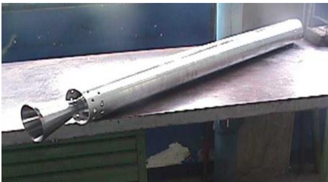
Fig. 6. Prototipo ensamblado del motor cohete fabricado en el laboratorio.
