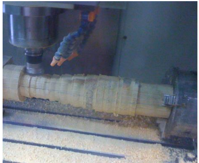
Fig. 7. Fabricación en máquina CNC del molde en madera para la ojiva.
