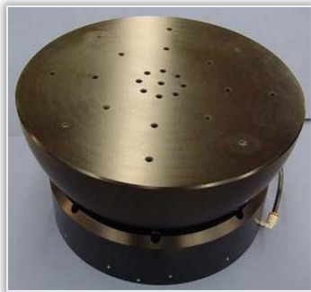
Figura 4: Modelo de Air Bearing, en el que se puede observar un "Inlet" para el suministro del aire comprimido
