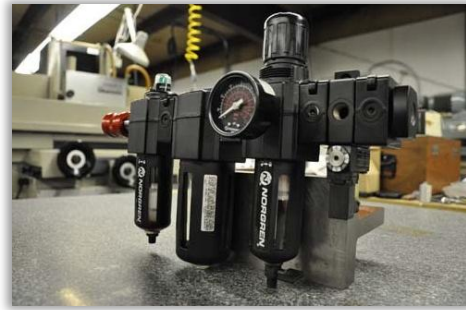
Figura 10: filtros de aire y secadores del sistema neumático
