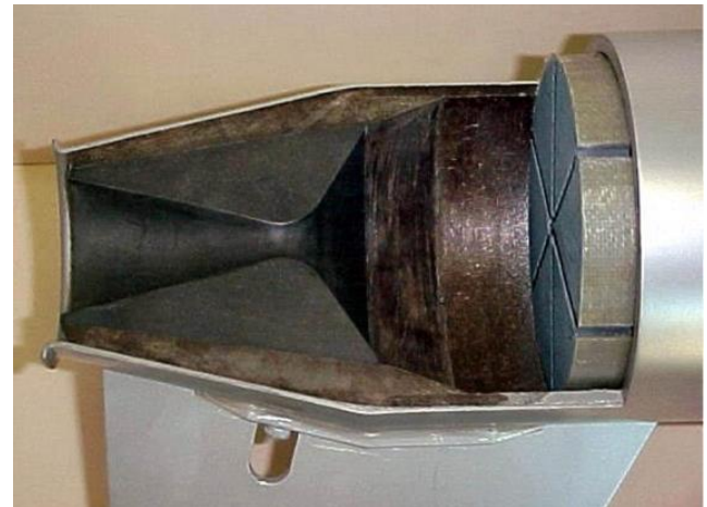
Fig. 11. Configuración de una tobera de cohete Super Arkas [10].
