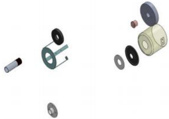
Fig. 8 Despiece del equipo formada por 4 resortes que se vencen con una fuerza axial de 0,5N, que se encuentran enclávalos mecánicamente entre una base y el pestillo.
