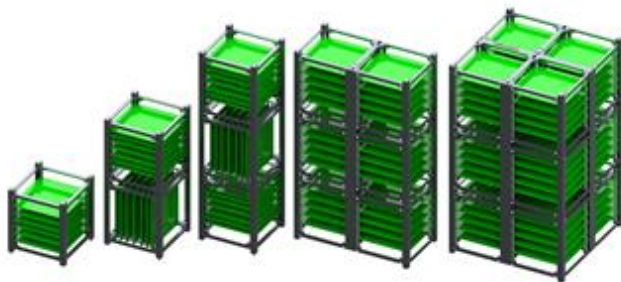
Fig. 1. Configuraciones de CubeSat desde 1U (izquierda) hasta 12U (derecha). Tomada del sitio web radiuspace.com.
