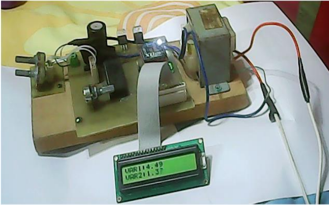
Fig. 16. Tarjeta del proceso industrial donde se observan todos los componentes del sistema.
