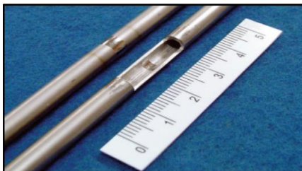
Figura 15 Tubos de Titanio Soldados por Soldadura Orbital [7].
