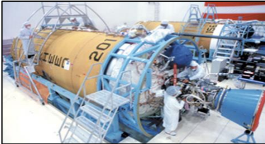
Figura 10 Los Técnicos del Lockheed Martin Space Systems Company montan el Sistema Propulsor de un Cohete Atlas [6].
