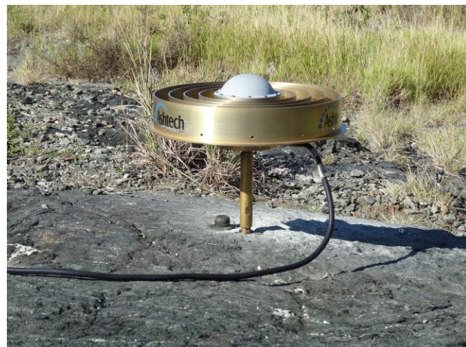
Fig. 2. Antena modelo Choke Ring instalada en el vértice MAN1 (Punta Manzanillo, Nueva Esparta). El dispositivo de rosca externa se encontró degradado por vandalismo (se observa ligeramente a la izquierda de la extensión de la antena) y fue sustituido por un modelo de rosca interna.
